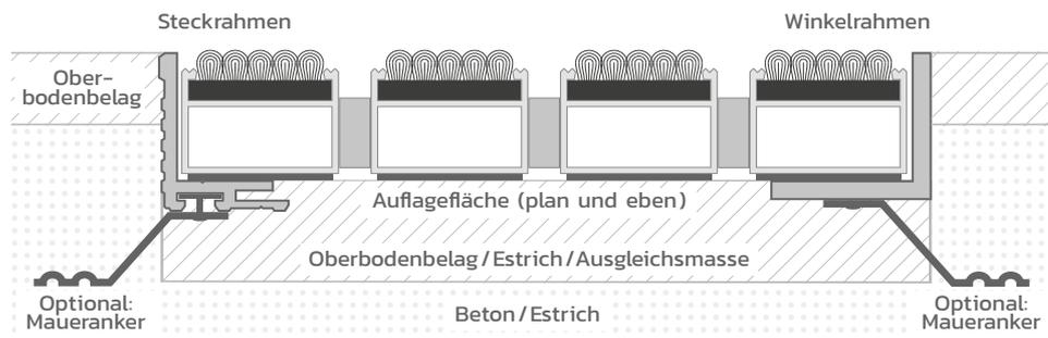
Anschließend wird der Rahmen ausgegossen, so dass die Rahmeninnenfläche plan und eben ist. Weist das Mattenbett Unregelmäßigkeiten auf, sind diese vor dem Einlegen der Matte auszugleichen. Wir empfehlen in diesem Fall eine flüssige Spachtelmasse aufzutragen.
